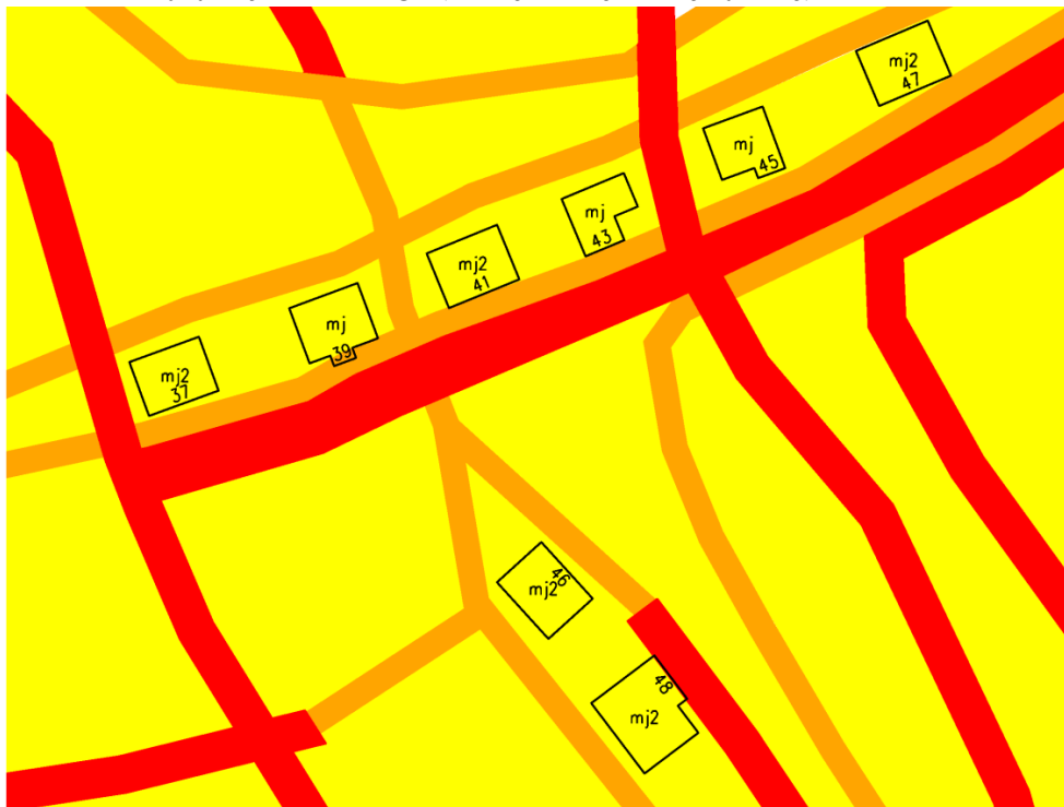
Rys 2. Mapa 2D ryzyka uszkodzenia podziemnego uzbrojenia (fragment) (kolor żółty – ryzyko małe, pomarańczowy – ryzyko średnie, czerwony – ryzyko duże)
