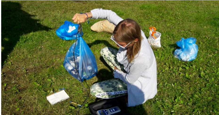
Źródło: opracowanie własne Rys. 4. Pomiar masy odpadów za pomocą wagi dynamometrycznej
