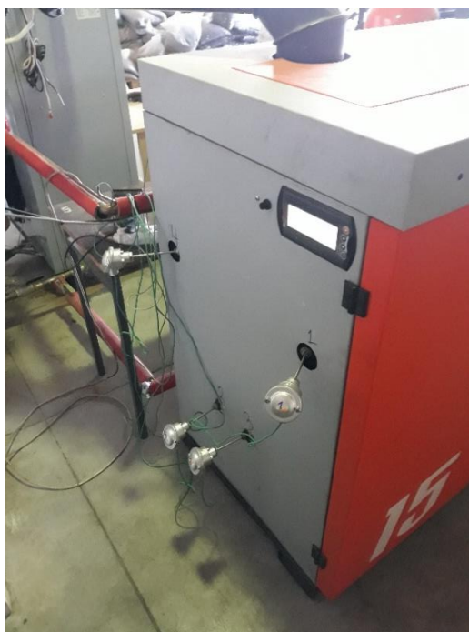
Rys. 27. Widok rozmieszczenia króćców pomiarowych przechodzących przez płaszcz wodny do komory spalania wraz z termoparami typu K
