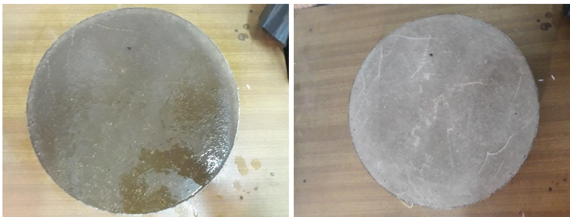
Rys. 19. Katalizator zawierający cząstki miedzi chwilę po natrysku (po lewej) oraz po procesie suszenia (po prawej)
