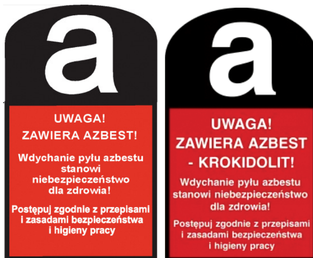
Ryc. 1. Wzór oznakowania instalacji lub urządzeń zawierających azbest oraz rur azbestowo-cementowych
