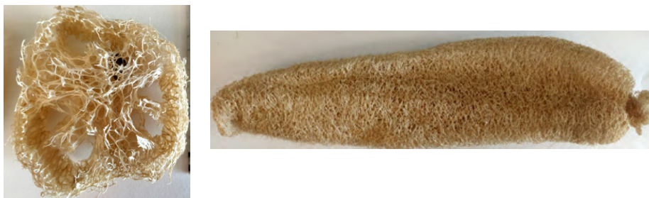
Rys. 1. Przekrój poprzeczny i wygląd zewnętrzny owocu Luffa cylindrica , uwidaczniający makroporową strukturę
